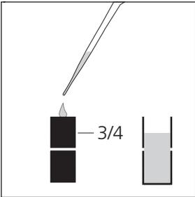
Membrankopf zu 3/4 mit KOH befüllen
