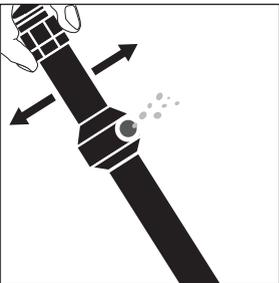
Durch leichtes Schwenken Luftblasen entfernen
