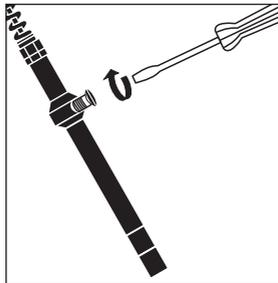
Nachfüllöffnung mit Verschlusschraube verschließen
