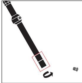
Membrankopf durch drehen entfernen
