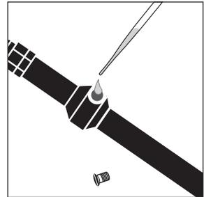
Sensor über die Nachfüllöffnung komplett mit KOH befüllen
