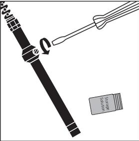
Verschlusschraube aus der Nachfüllöffnung schrauben
